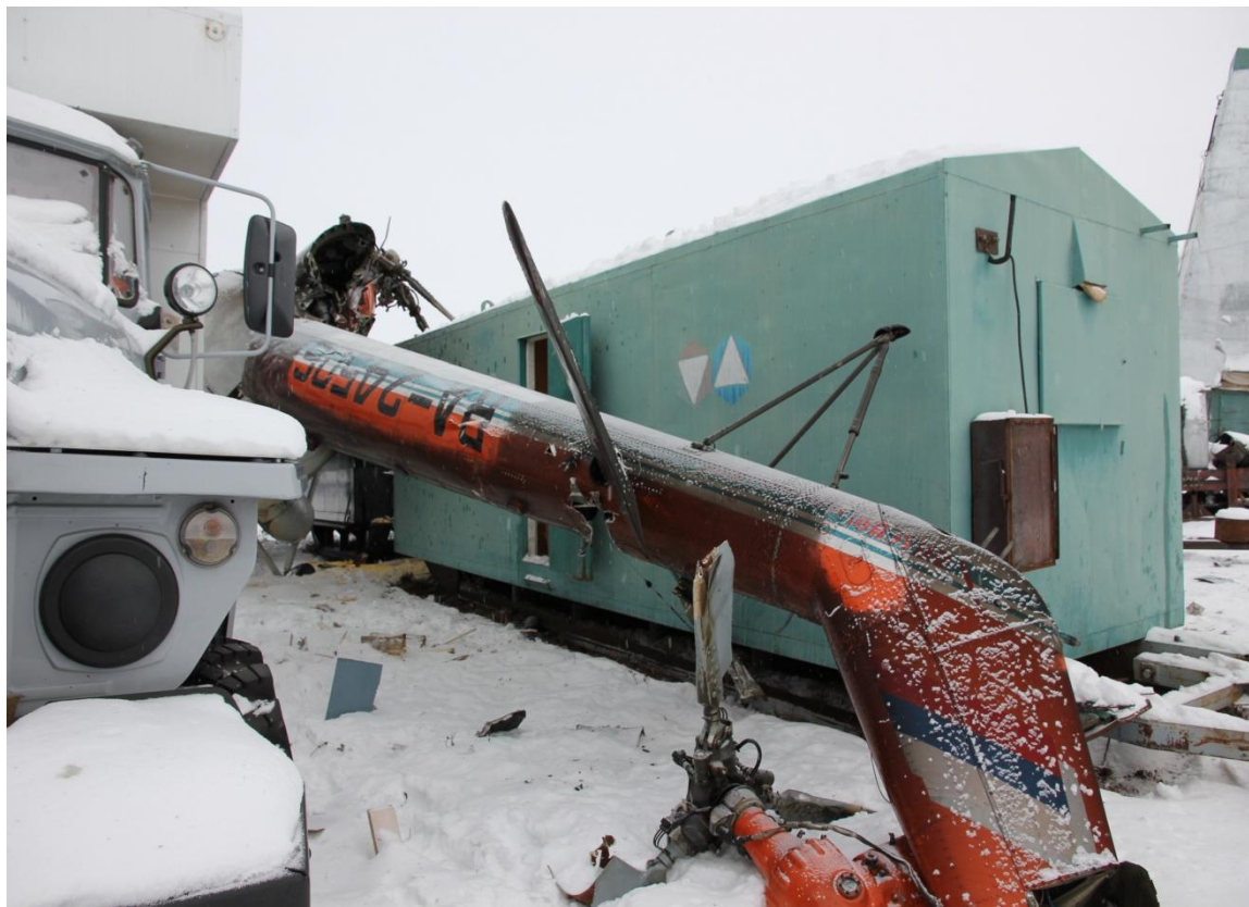
Рис. № 2. Вертолёт на месте АП (хвостовая балка).
