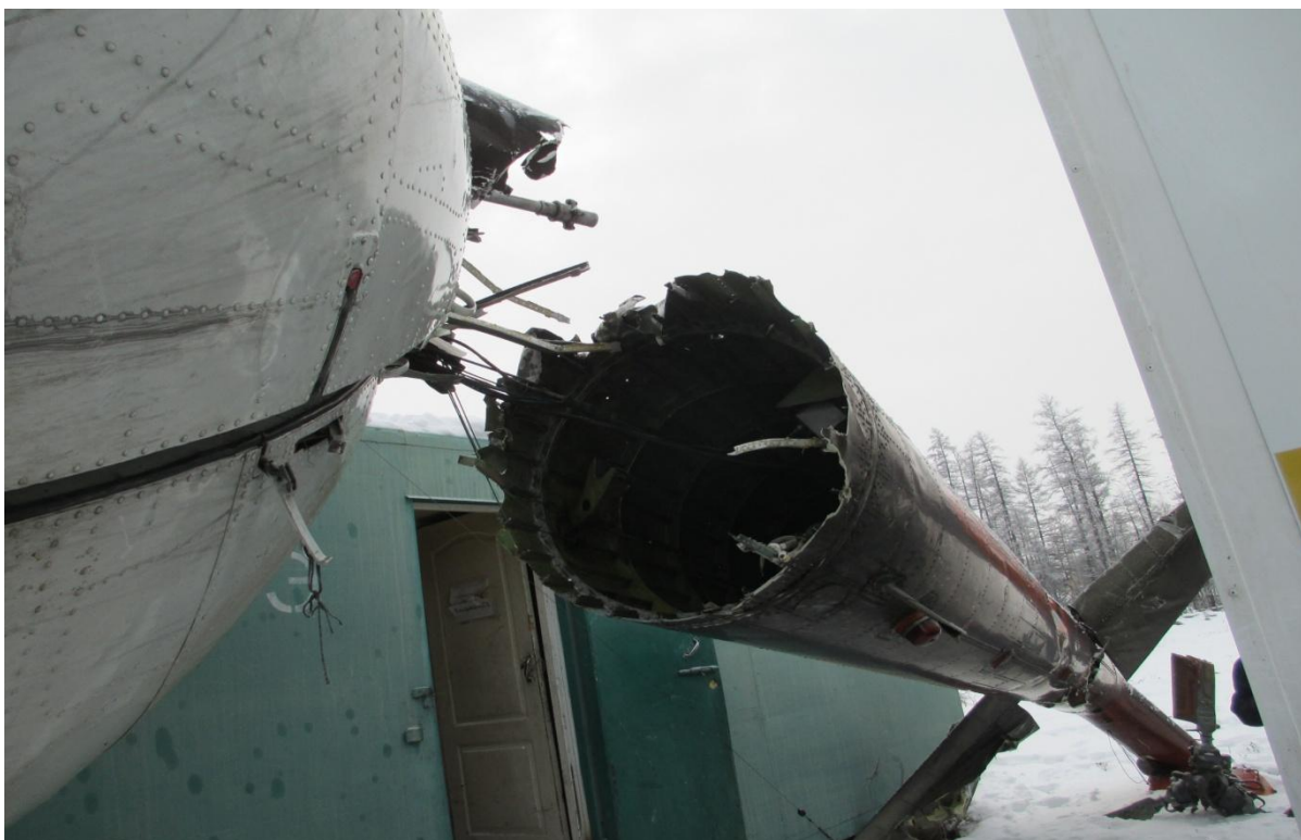
Рис № 6. Оторванная хвостовая балка вертолёта.
